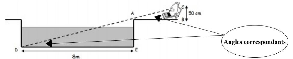
Ainsi les triangles ABC et ADE ont deux angles deux à deux de même mesure. Donc ils sont semblables et les longueurs des côtés homologues sont proportionnelles. D'où :  $\frac{BC}{AE} = \frac{AB}{DE}$ . Ainsi  $\frac{0,5}{AE} = \frac{1}{8}$  et  $AE = \frac{8 \times 0,5}{1} = 4 \text{ m.}$
